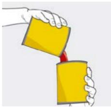
Vacía el **componente A** en el **B** y mézclalos durante 3 minutos hasta obtener un color uniforme.
