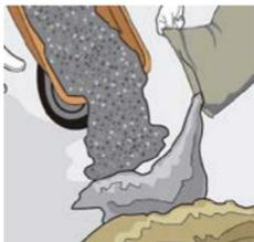
Calcula la cantidad necesaria de **Sikalite**<sup>®</sup> de acuerdo con la cantidad de cemento utilizado en la mezcla. Agréguelo junto con la grava y la arena si es concreto o a la arena si es mortero, previo a la adición de agua.
