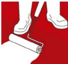
Aplicar una segunda capa de **Imper Sika® Rápido** perpendicular a la primera y a razón de 0.5 mm por capa. Dejar secar 2 horas.
