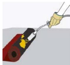
Aplica el **Sika® Imper Manto**, aplicando calor por medio de soplete en la cara inferior, hasta fundir la película transparente y logrando que el asfalto se adhiera a la superficie imprimada.
