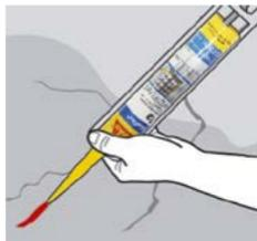
Aplica primario. Diluye el **Imper Sika® Rápido** en proporción 1.5 (producto: agua) en volumen, aplica con rodillo o brocha y deja secar 2 hrs. Sella grietas abriendo caja y sellando con **Sikaflex® -1a**.
