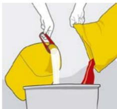
Mezcla en un recipiente limpio coloca el componente A (líquido) y vacía el componente B (polvo) en forma gradual, hasta obtener una pasta homogénea sin grumos.
