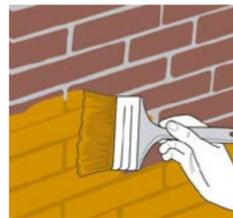
Aplica la lechada/mortero con brocha o cepillo hasta obtener una capa de 2 a 3 mm de espesor.
