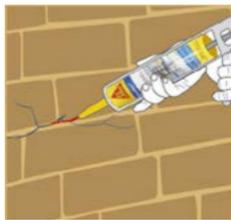
Sella las juntas y grietas con **Sikaflex® -1a o Sikaflex® Construction Sealant**.
