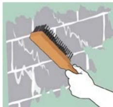
Raspa la superficie retirando los daños 30 cm por encima y al lado de la humedad existente con un cepillo de cerdas metálicas.
