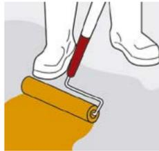
Aplica una capa de **Imper Sika® Rápido** sin diluir en toda la superficie con un mínimo de espesor de 0.5 mm por capa y déjalo secar 2 horas.
