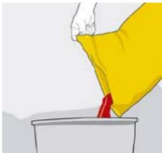
Vacía **SikaGrout® Constructor** de forma gradual y mezcla constantemente. Evita dejar grumos.
