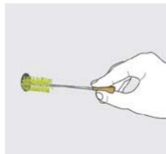
Limpiamos la perforación con cepillo de metal y una bomba de soplado o compresor (\*).
