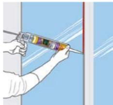
**Aplica Sikasil® Universal** evitando atrapar aire y la formación de burbujas. Aplica un cordón de 6 mm de lado en la unión.
