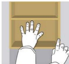
Coloca la pieza en la posición deseada, presiona y muévela ligeramente para extender el adhesivo entre las superficies y sostenla hasta que este fija.
