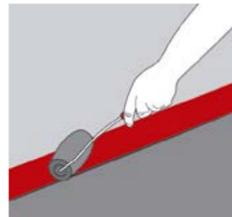
Finalmente alisa usando un elemento de madera recubierto con un trapo o un rodillo de goma.
