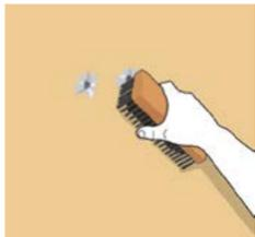
Limpia la superficie. Elimina polvo, partes mal adheridas y restos de pintura.
